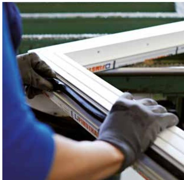
Innovants et indéformables, les cadres en PVC garantissent à la porte d'entrée Finstral une protection acoustique optimale. Le ferrage et les deux joints périphériques, intérieur et central, contribuent efficacement à laisser les bruits à l'extérieur.
